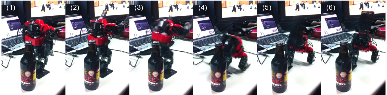
図 7．直接教示による海老蹴りの振り付け．(1) びんの背後に立つ．(2) 両手を振り上げる．(3) 勢いよく前のめり．(4) 両手を床に付く．(5) 右足でびんを蹴る．(6) 右足を蹴り上げる．
