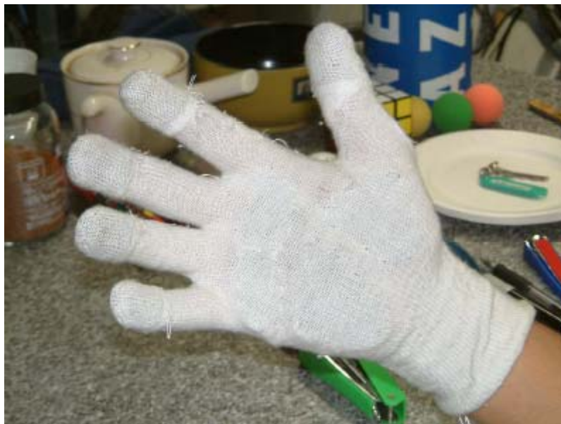
図4.8 触覚センサーを配置したグローブ；センサーが適切な場所に常に適合すると保証するために，センサーは，細い弾性繊維グローブの内部に付けられる．それはCybergloveの下で着用していることになっている．設計は，両方の入力装置を別々に使用することも可能にしている．
