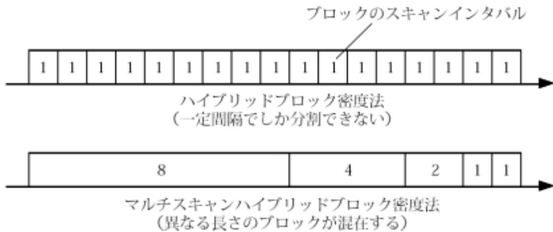
図 3.11： マルチスキャンハイブリッドブロック密度法でのブロック分割方式
