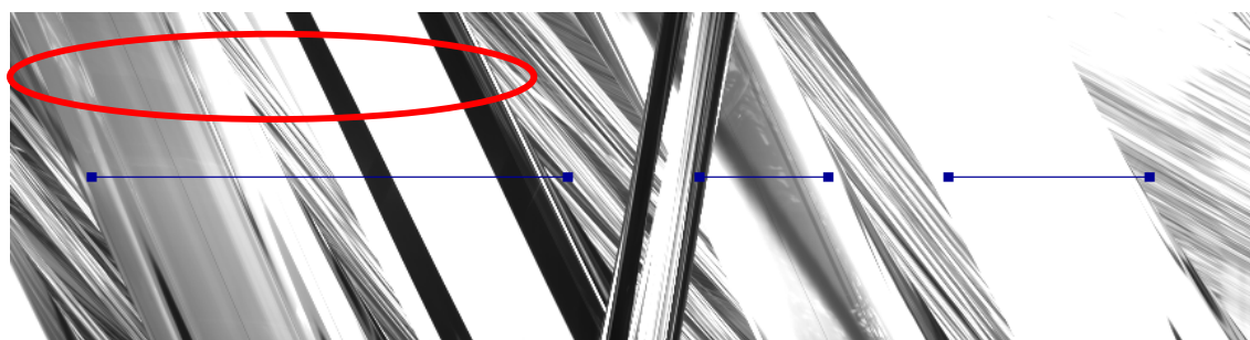
図 6-5: 複数台が1台に認識されることによる認識漏れ
