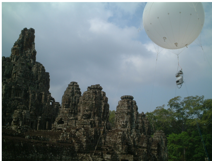
図 4.5: 目的の箇所を計測できる位置まで気球センサを操作
