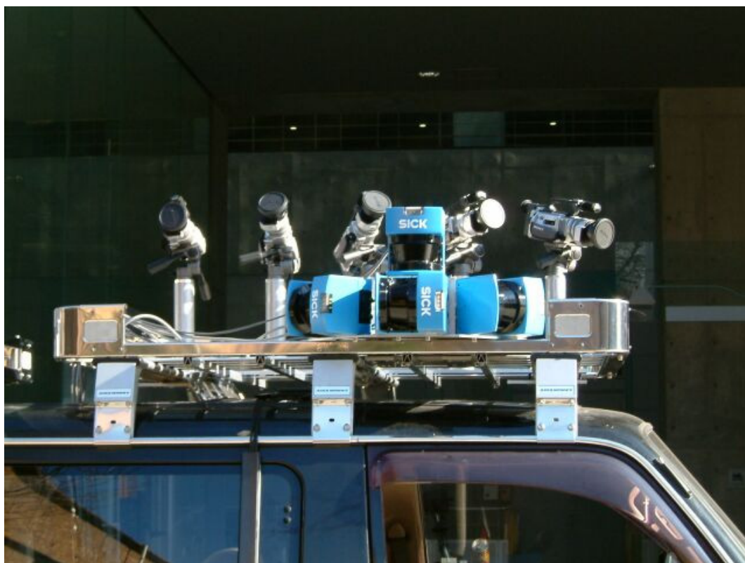
図 4.2: データ収集用レンジセンサおよび車両
