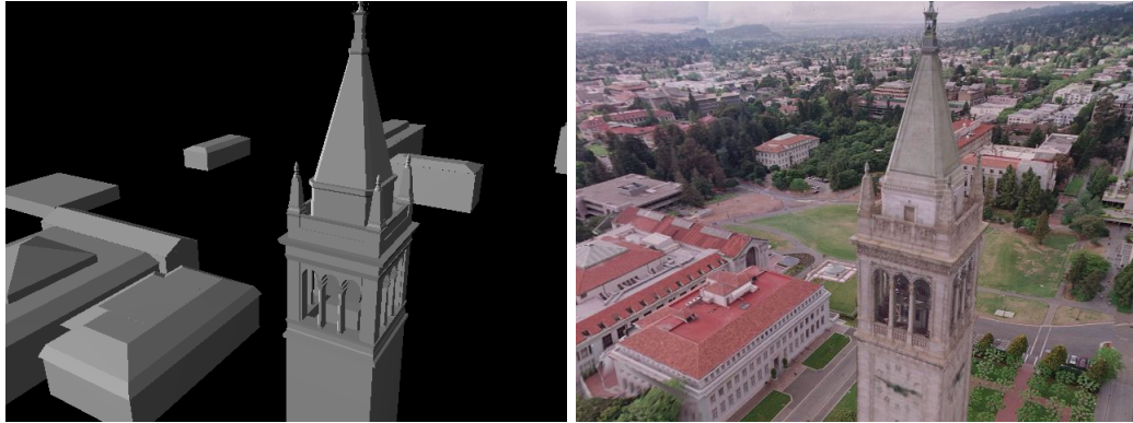
図 2.2: Debevec による 3 次元形状の復元 (その 1) ムービー中の 16 枚の画像からポリゴンモデルを生成する。この例では右側の画像を生成している。また標準的なグラフィック用のハードウェアでリアルタイムでレンダリングが可能である。
