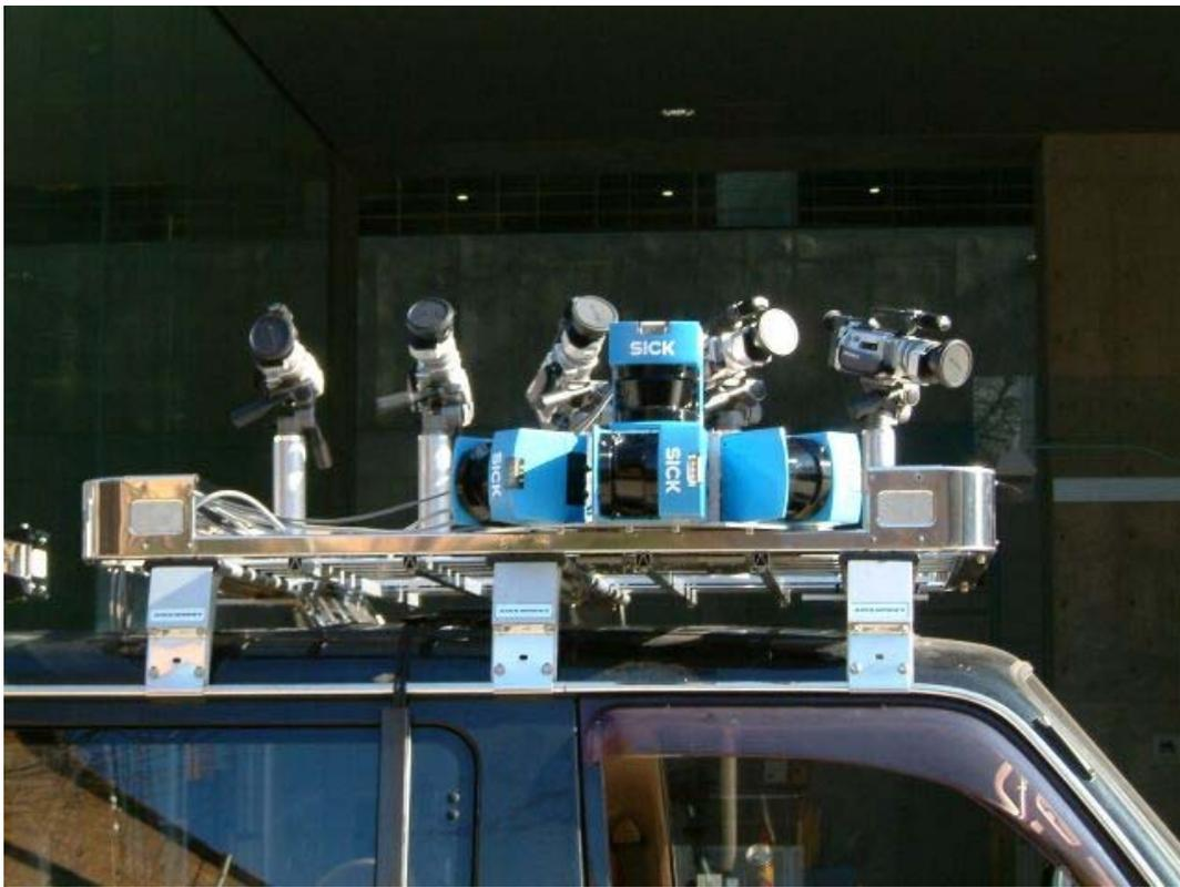
図 2.8 データ収集用レンジセンサおよび車両
