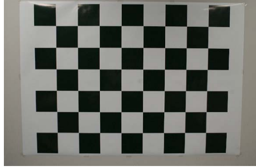
図 2.12: レンズ歪み測定用パターン
