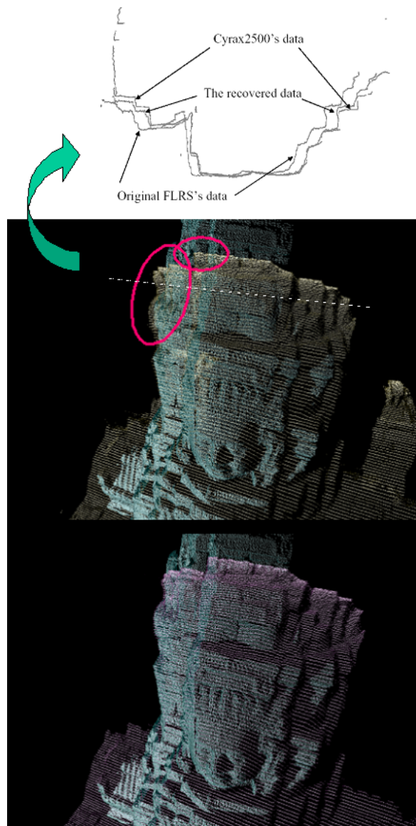
図5 地上固定レンジセンサとの比較: 中央 FLRS から得られたオリジナルデータ, 下 提案手法によって修復したデータ, 上-中央の図で点線で示した部分をカットした断面図
