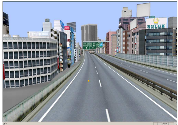
図1: ジオメトリベースによるドライブシミュレータのドライバ周辺環境画像
